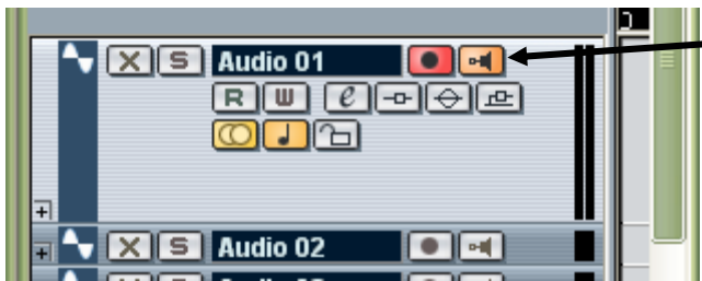
Dans Cubase SX, le fait d'allumer ce bouton indique au logiciel qu'il doit renvoyer le son entrant (après traitement) vers la sortie.
